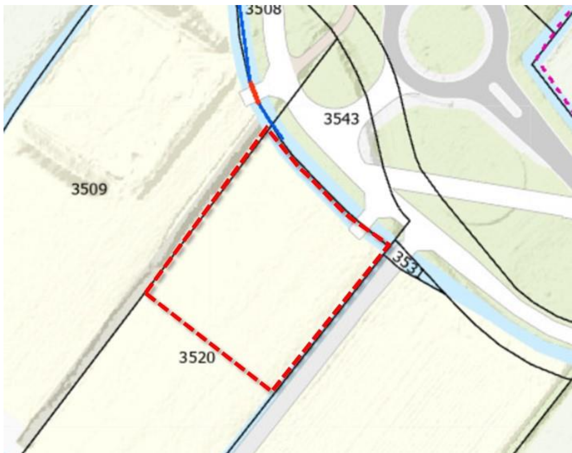
afbeelding 10: uitsnede Legger Wetterskip met de watergangen aangegeven en de grens van het projectgebied is globaal aangeduid met een rode stippellijn
